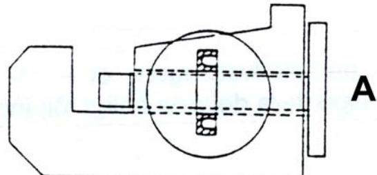
Ta stempelpakningen ut av klippehodet. Bytt pakningen dersom den er skadet eller slitt. Plasser pakingen som fig. A viser.
